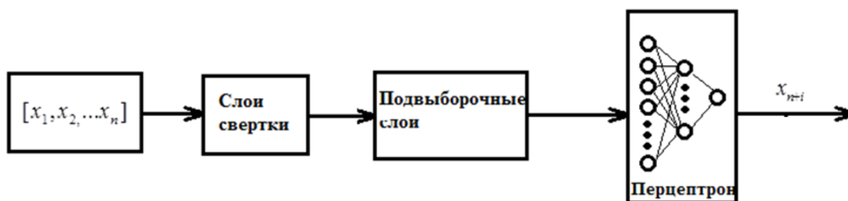
Рисунок 1 – Структурная схема сверточной нейронной сети для одношагового прогнозирования
